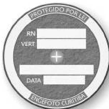
FIGURA 20 - MODELO CHAPA METÁLICA A SER UTILIZADA NO PROJETO
