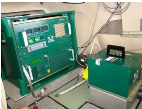
FIGURA 7 - PERFILADOR LASER OPTECH ALTM GEMINI 167
